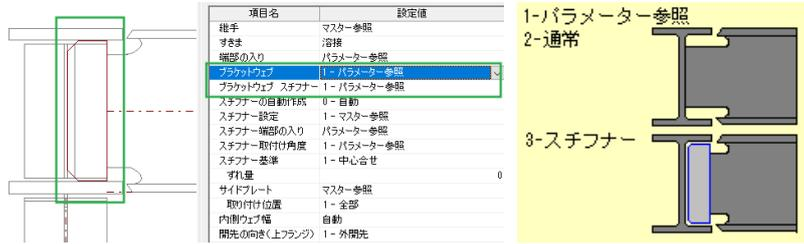
ガセット・2面せん断・溶接継手・ブレースシートが取り付く仕口に、「スチフナーの自動作成：2-あり」で、縦スチフナーの設定が可能になりました。
