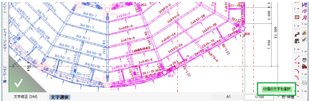
単独寸法で、終点指定の時に、文字位置「任意」を追加しました。文字自動で寸法を作成し、配置時に寸法数値が修正できます。
